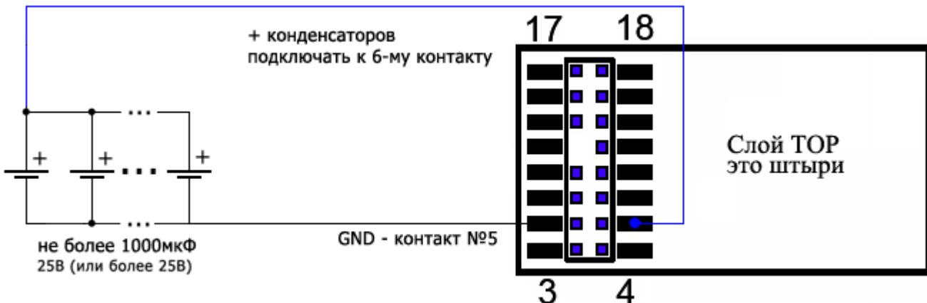
При использовании встроенного ограничителя тока заряда емкость подключаемого конденсатора должна быть не более 1000мкФ. Если вы хотите подключить конденсатор емкостью более 1000мкФ, то необходимо использовать дополнительный внешний ограничитель тока (резистор с диодом) и подключать плюс конденсатора не к 6-му, а к 9-му контакту. (См. схему в инструкции к SoundGT2 micro)
